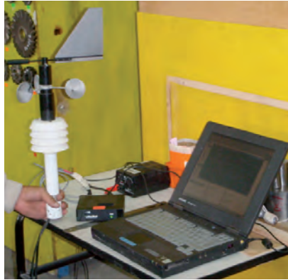
Figura 3. Sistema para registro de datos entregados por el anemómetro de cazoletas
