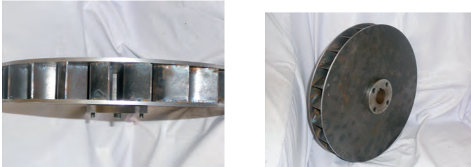
Figura. 5 Rueda Hidráulica Modelo (Diámetro 30 cm)
