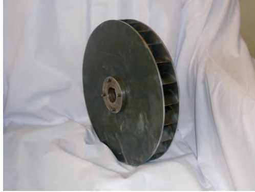
Fig. 10 Rueda Hidráulica Prototipo de un diámetros de 1,7 m.
