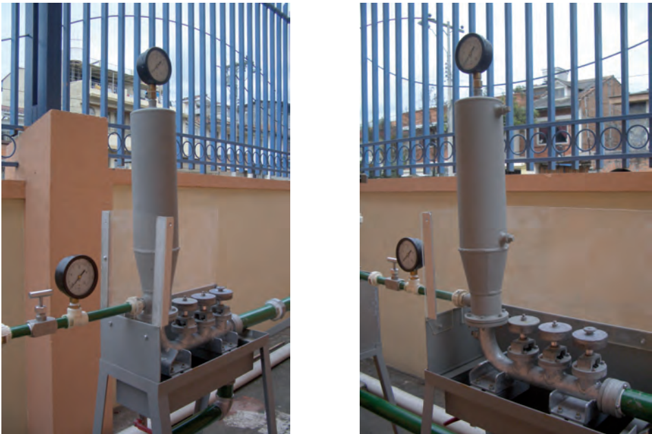
Figura 13. Banco para pruebas de bomba de ariete hidráulico multipulsor
