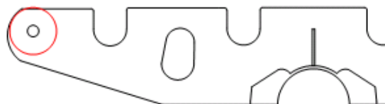
Fig. 2.45.- Ubicación de la parte crítica
