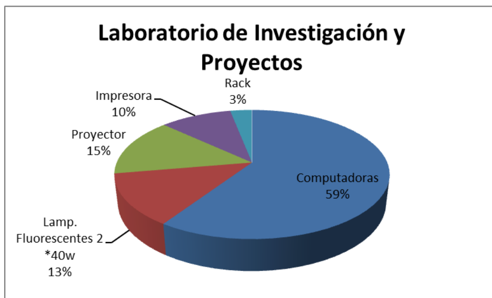
Figura 69.27 Consumo de Energía en Kwh a plena carga Fuente: Los Autores
