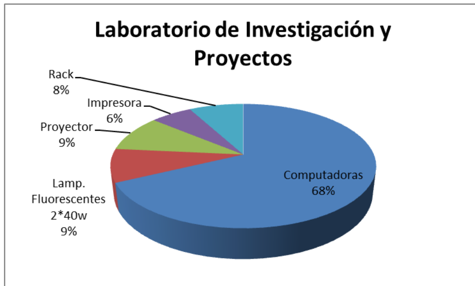
Figura 70.28 Consumo en Kwh del Laboratorio de Investigación y Proyectos sin carga Fuente: Los Autores
