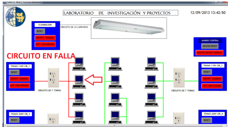
Figura 34.27 Falla de Circuito Fuente: Los Autores
