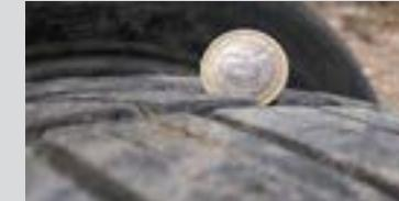
Figura 4.72 Comprobación de él estado de la llanta de Emergencia: Fuente [LOS AUTORES]
