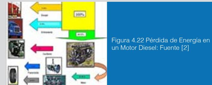
Figura 4.22 Pérdida de Energía en un Motor Diesel: Fuente [2]
