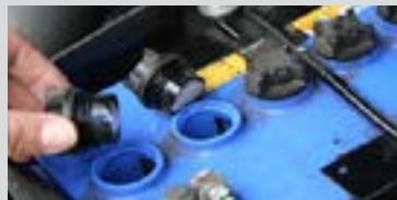
Figura 4.68 Comprobación del nivel del líquido de electrolito de la batería: Fuente [LOS AUTORES]
