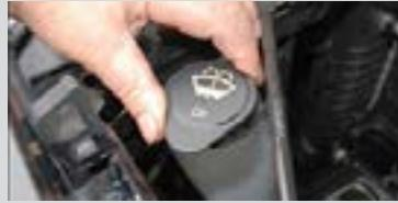
Figura 4.65 Comprobación del nivel del líquido limpiaparabrisas: Fuente [LOS AUTORES]
