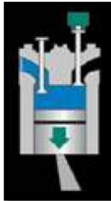
**Figura 2.117 Diagrama, funcionamiento frenos Jacobs: Fuente [41]**
