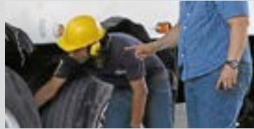
Figura 4.43 Revisión del estado de las llantas: Fuente [LOS AUTORES]
