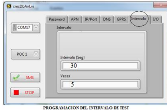
Figura 3.17 Pantalla de configuración intervalo de monitoreo simulado en LabView [4].
