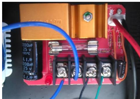
Figura 3.32 Sistema de alimentación del equipo con recarga automática de batería.
