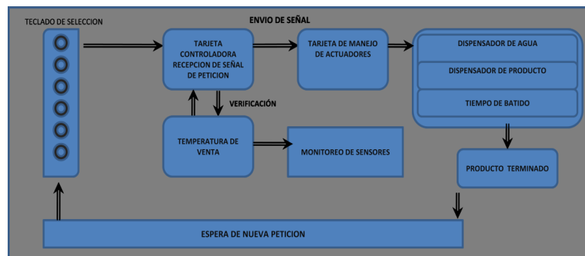
Figura 1.20 Diagrama de bloques del funcionamiento de una máquina dispensadora. Fuente [Autores]
