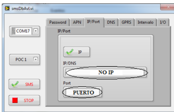
Figura 3.15 Pantalla de configuración No-IP simulado en LabView Development System [4].
