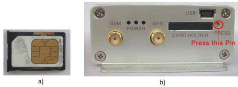
Figura 2.7 Ubicación de la memoria SIM [1]. a) tarjeta SIM. b) Socket de tarjeta SIM.
