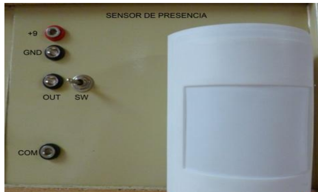
Figura 39. Fotografía y esquema interno del módulo sensor de presencia
