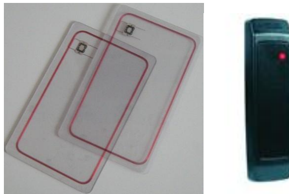
Figura 27. Tarjetas de proximidad y lector de tarjetas
