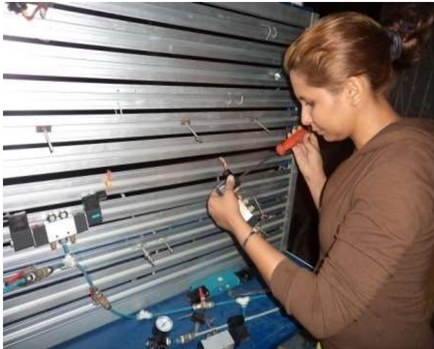
Figura A29: Desmontaje del tablero original
