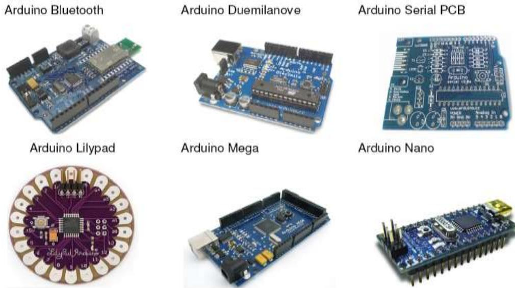
**Figura 2.8:** Modelos de las tarjetas Arduino
