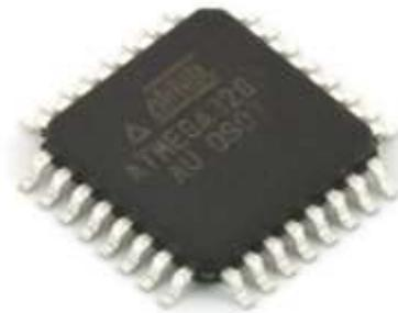
**Figura 2.5:** Microcontrolador ATMEGA 328
