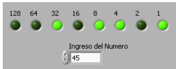
**Figura 4.58:** Leds muestran la conversión decimal en binario
