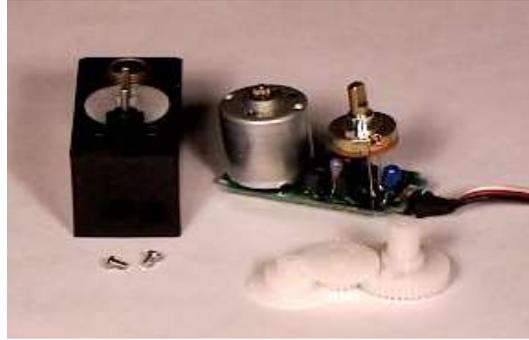
**Figura 3.2:** Servomotor desmontado
