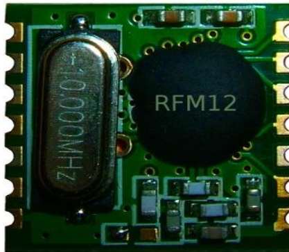
Gráfico 26: Transceptor inalámbrico RFM12
