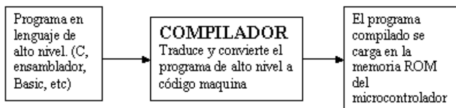
Gráfico 8: Diagrama de Bloques de la Compilación
