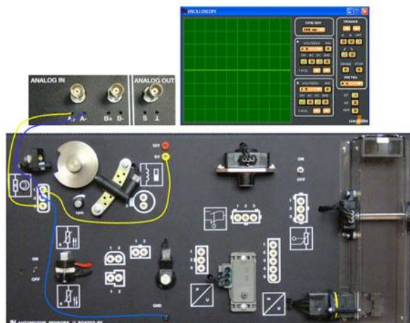
Figura 47 Conexión del Voltímetro en el sensor efecto hall
