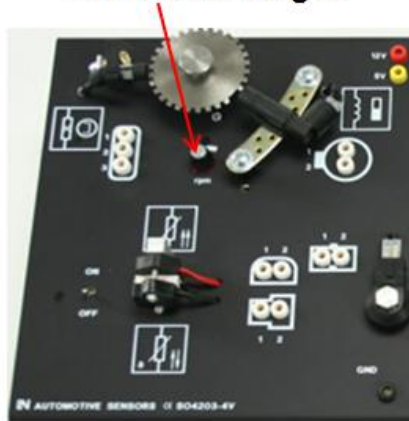
Figura 48 Ubicación del Potenciómetro de control de giro del motor Potenciómetro para controlar la velocidad de giro
