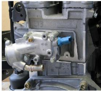
Figura 6 Resistencia NTC, Montada en la caja del termostato
