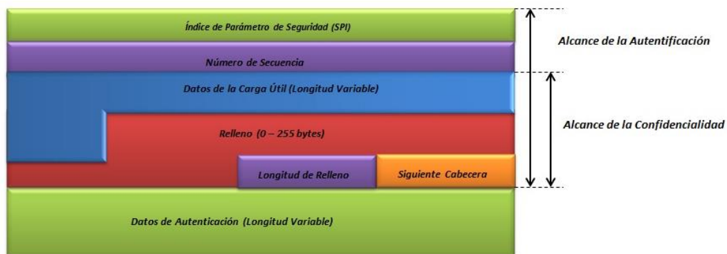
Figura 29 Formato de la cabecera de carga de seguridad encapsulada ESP
