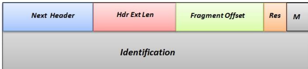
Figura 12 Cabecera de Extensión Fragment Header
