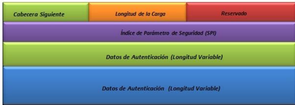
Figura 26 Formato de la Cabecera de Autenticación AH
