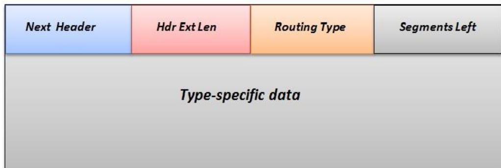
Figura 11 Cabecera de Extensión Routing Header
