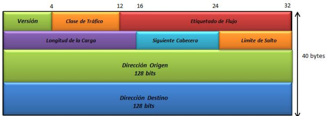
Figura 8 Formato de la Cabecera IPv6
