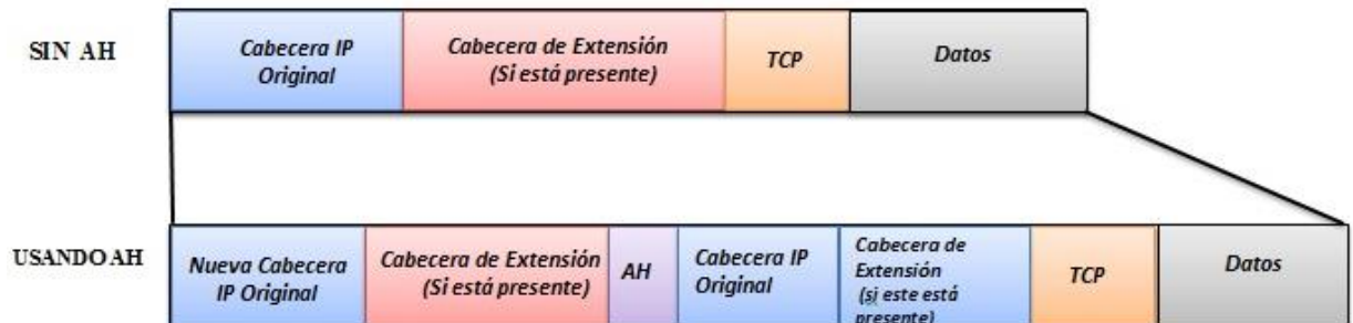
Figura 28 Localización de la cabecera de autenticación en modo túnel
