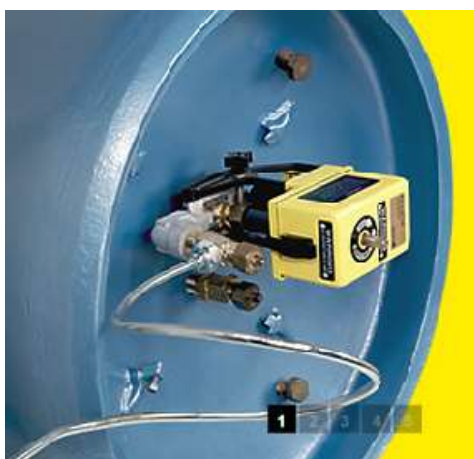
FOTO 7: ACTUADOR DE CIERRE DE EMERGENCIA PARA CONTENEDORES CON GAS CLORO DE 907 KG.
