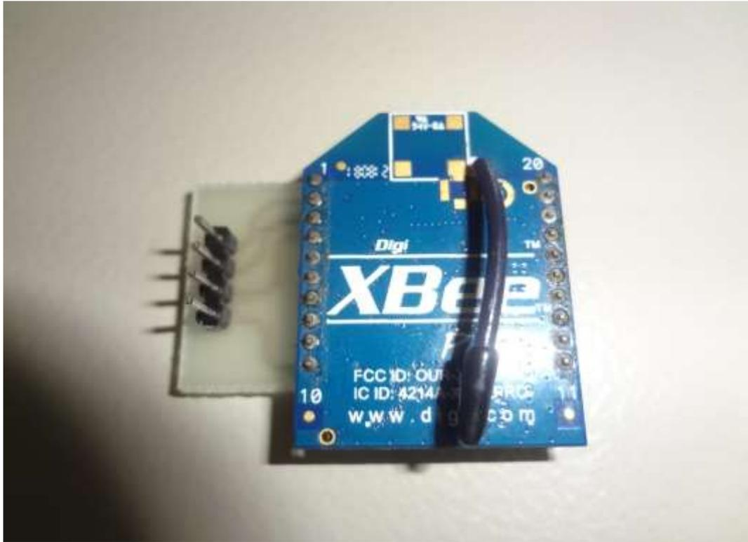
FOTO N° 30: PINES UTILIZADOS PARA COMUNICACIÓN INALÁMBRICA DEL XBEE
