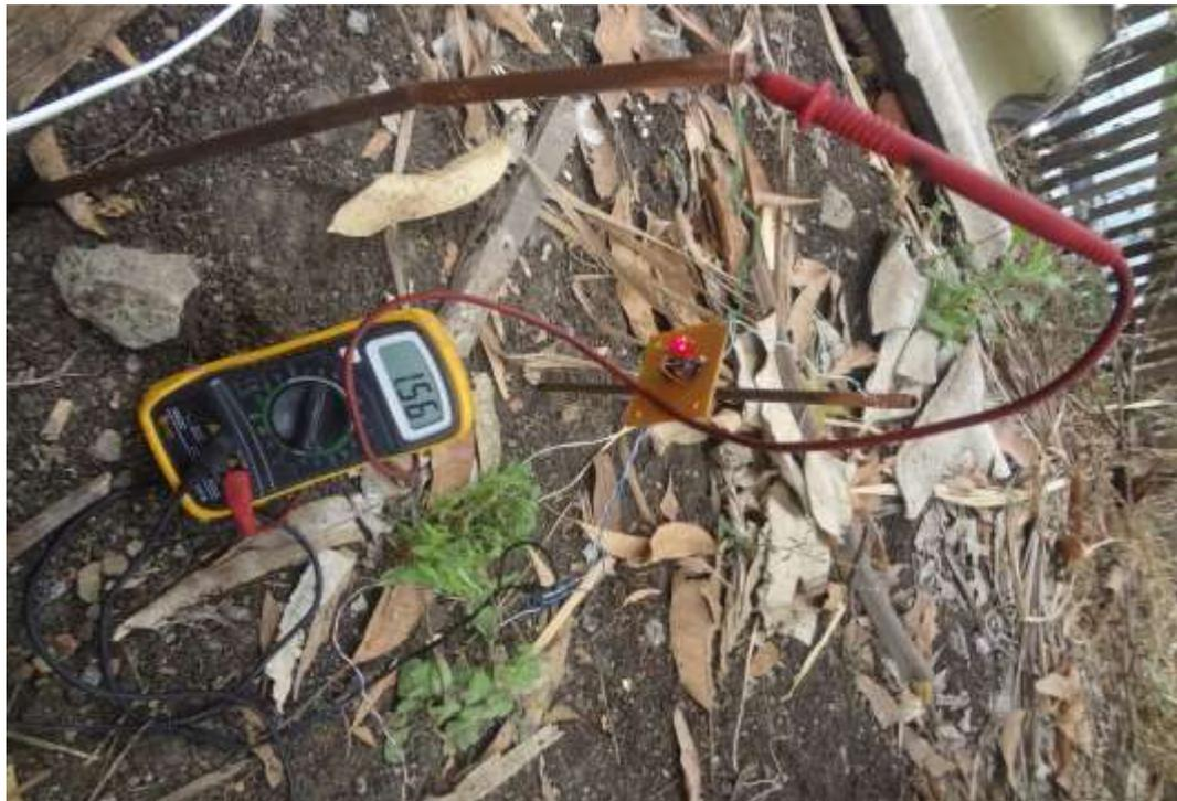
FOTO N° 15: MEDICIÓN DE RESISTENCIA EN EL TERRENO CON SENSOR DE HUMEDAD
