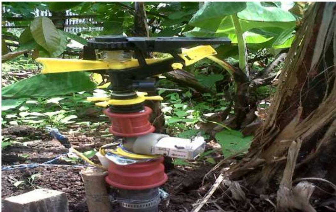
FOTO N° 5: ELECTROVÁLVULAS Y ASPERSORES PARA IRRIGACIÓN DEL
