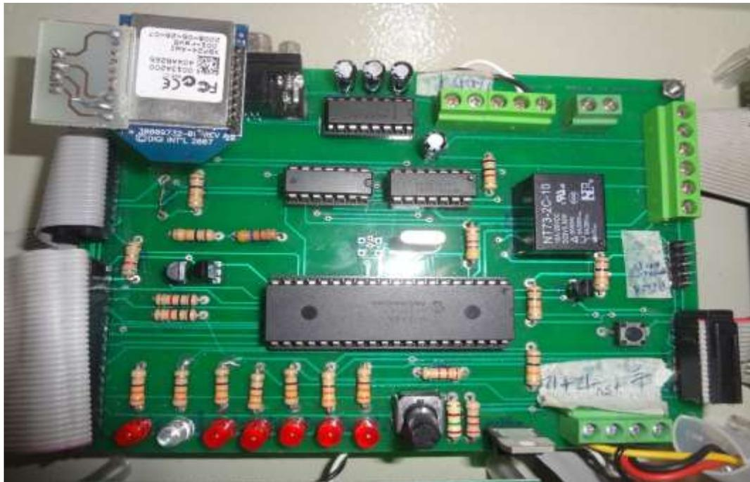
FOTO N° 29: TARJETA PRINCIPAL DEL CONTROLADOR Y MANEJO DE COMUNICACIÓN
