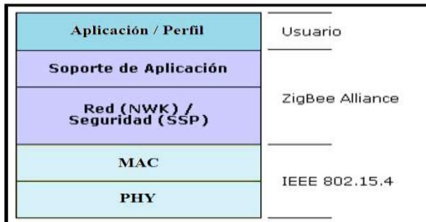
FIGURA N° 9: CAPAS QUE CONFORMAN LA PILA DE PROTOCOLOS ZIGBEE
