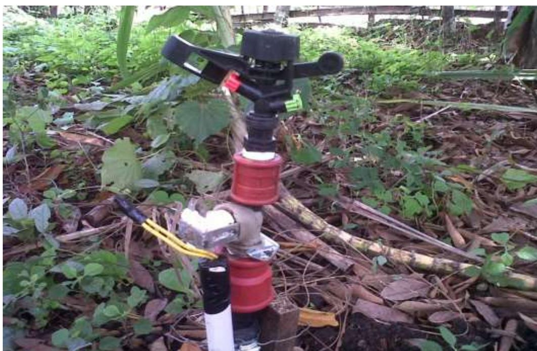
FOTO N° 9: ELECTROVÁLVULAS Y ASPERSORES PARA IRRIGACIÓN DEL
