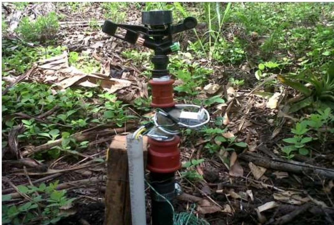
FOTO N° 11: ELECTROVÁLVULAS Y ASPERSORES PARA IRRIGACIÓN DEL
