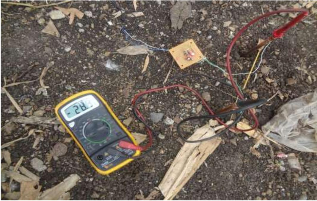
FOTO N° 14: MEDICIÓN DE TENSIÓN EN EL TERRENO
