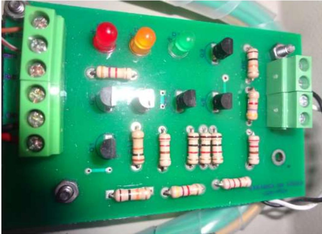
FOTO N° 32: TARJETA DE SENSOR DE NIVEL DEL SISTEMA DE RIEGO
