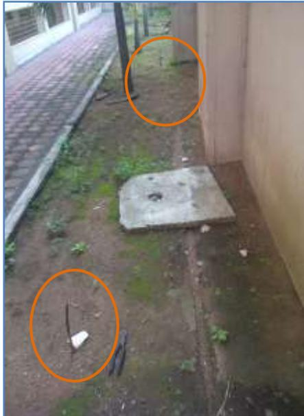
**FOTOGRAFÍA 3.69:** PINZA COCODRILO AJUSTADO AL ELECTRO PARA DETERMINAR EL VALOR DE RESISTIVIDAD DEL SUELO
