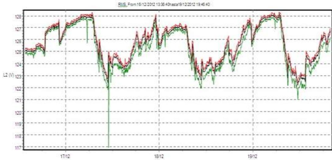
Fuente: Equipo analizador trifásico de energía FLUKE 435, Dato: 16/12/2012 a 19/12/2012
