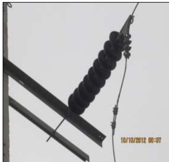
GRÁFICO III- 12 Aislador de Suspensión (Norma ANSI 52- 4).
