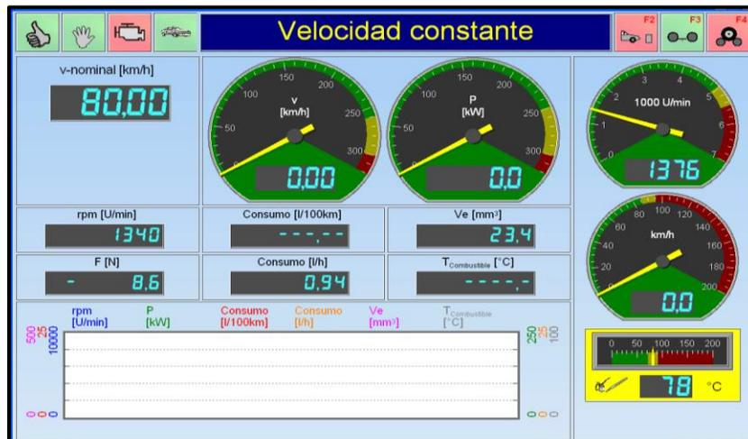
Figura 3.17 Medición de la potencia iniciada en KW
