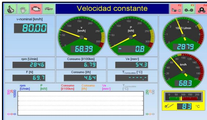
Figura 3.16 Medición de la potencia iniciada en KW
