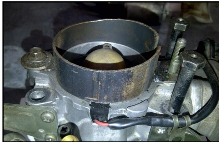
Figura. 2.11. Acople de la entrada de aire en el T.B.I
