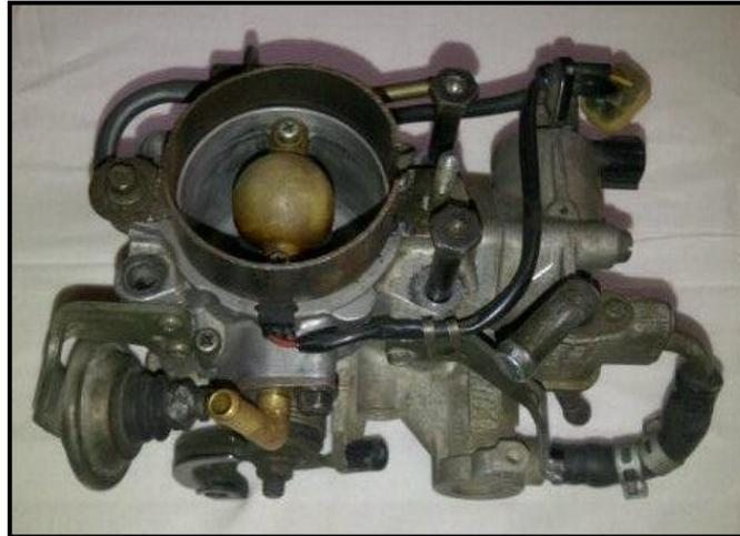
Figura. 2.6 T.B.I a utilizarse en el vehículo Suzuki Forsa
