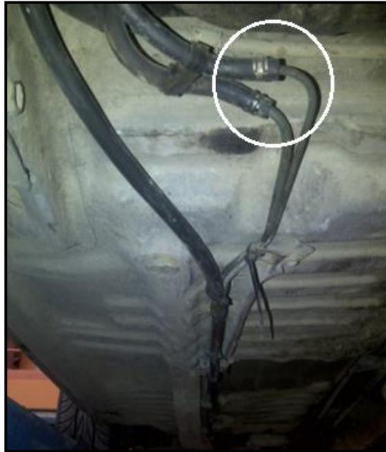
Figura. 2.3. Acople de la cañería de combustible.
