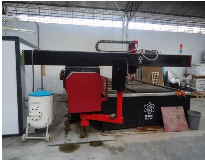
**Ilustración 13:** Área de Corte por Chorro de Agua
