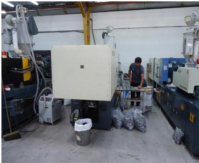
**Ilustración 43:** Inyectora, Riesgo de Movimientos Repetitivos (De pie)
