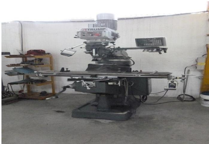
**Ilustración 21:** Fresadora Vertical, Riesgo Atrapamiento por o entre Objetos
