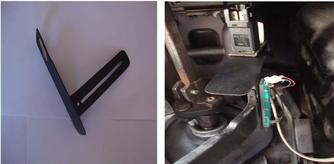
**Figura 3.17.** Base del Potenciómetro del Pedal de Freno.
