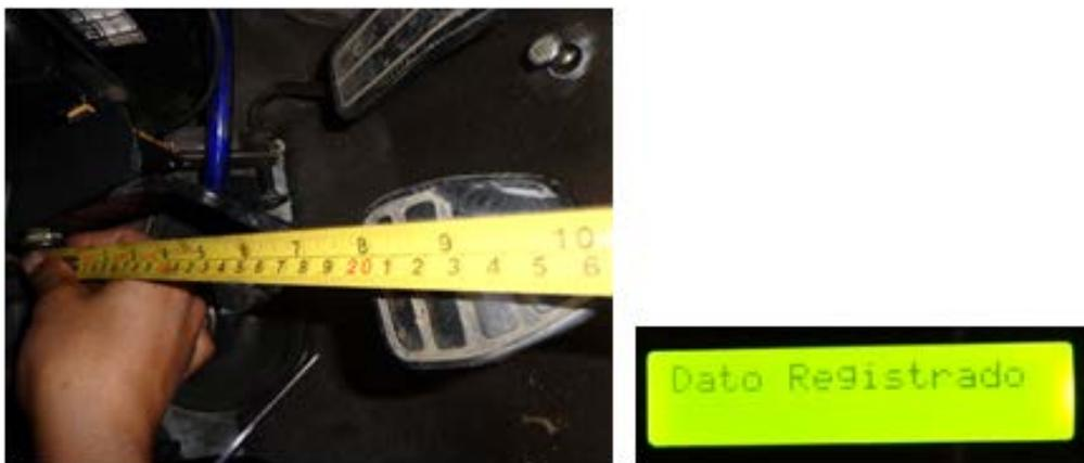
**Figura 3.18.** Toma de Datos de la Fuerza Ejercida en el Pedal y Mensaje de Información Grabada
