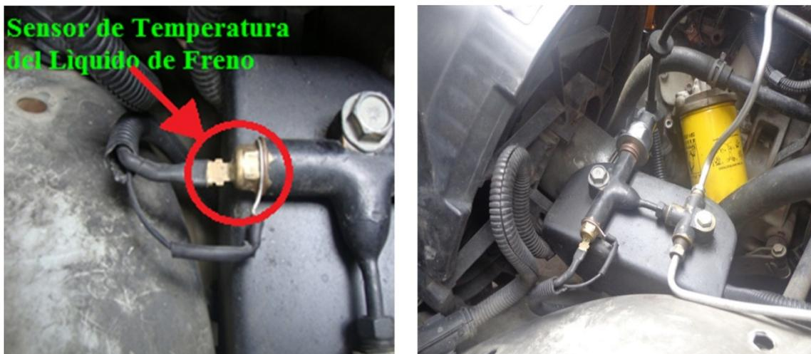
**Figura 3.35.** Montaje del Sensor de Temperatura del Líquido de Freno
