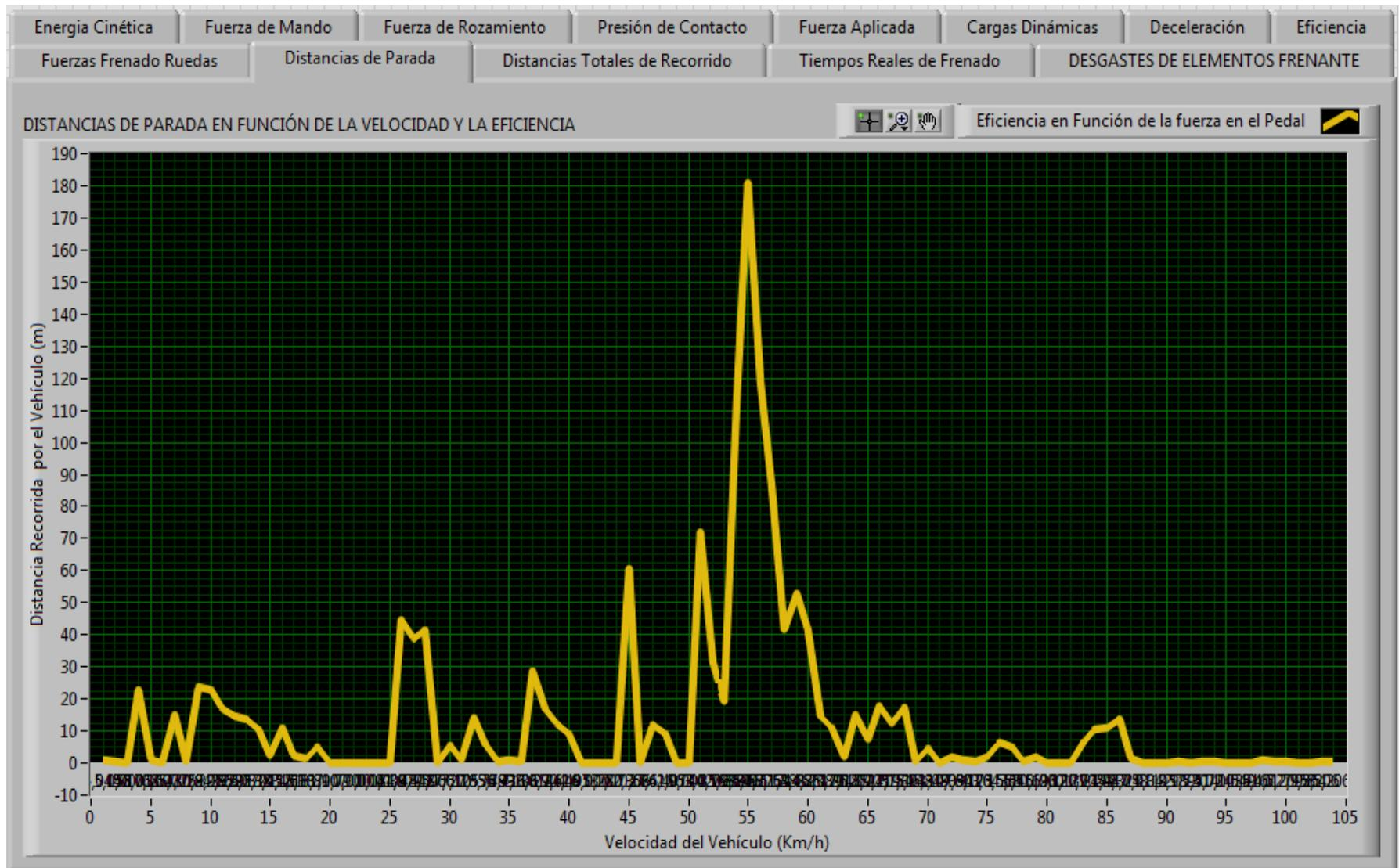
**Figura 4.37.** Distancia de Parada en Función de la Fuerza de la Velocidad y la Eficiencia.
