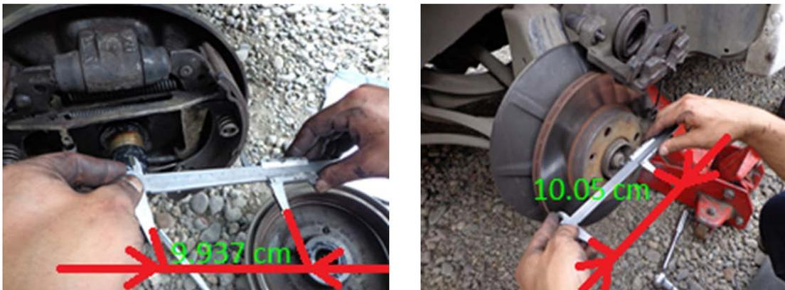
**Figura 4.18.** Dimensiones Tomadas en Discos y Pastillas.
