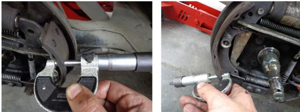
**Figura 4.41.** Obtención del Dato de Espesor de Zapata.
