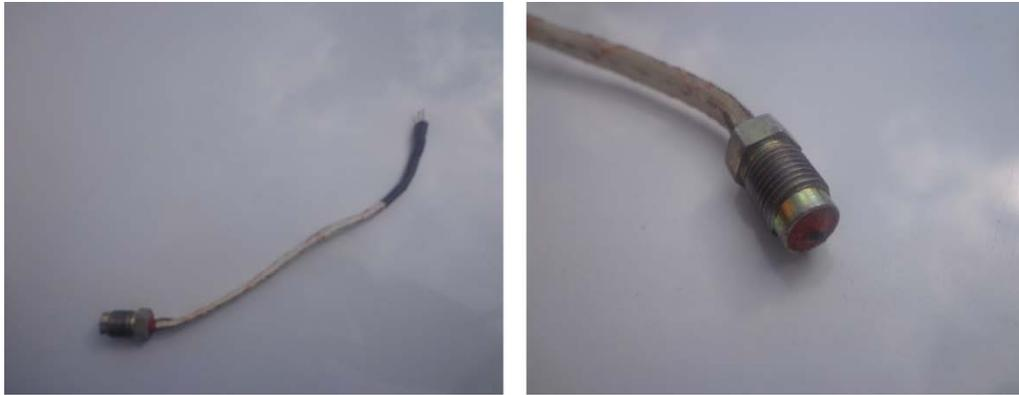
**Figura 3.22.** Ensamblaje de NTC para Facilitar su Montaje.
