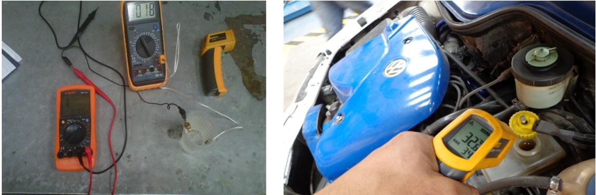
**Figura 3.36.** Pruebas para la Adquisición del Sensor de Temperatura del Líquido de Freno.
