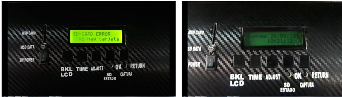
**Figura 3.51.** Funcionamiento del Sistema sin Tarjeta SD.
