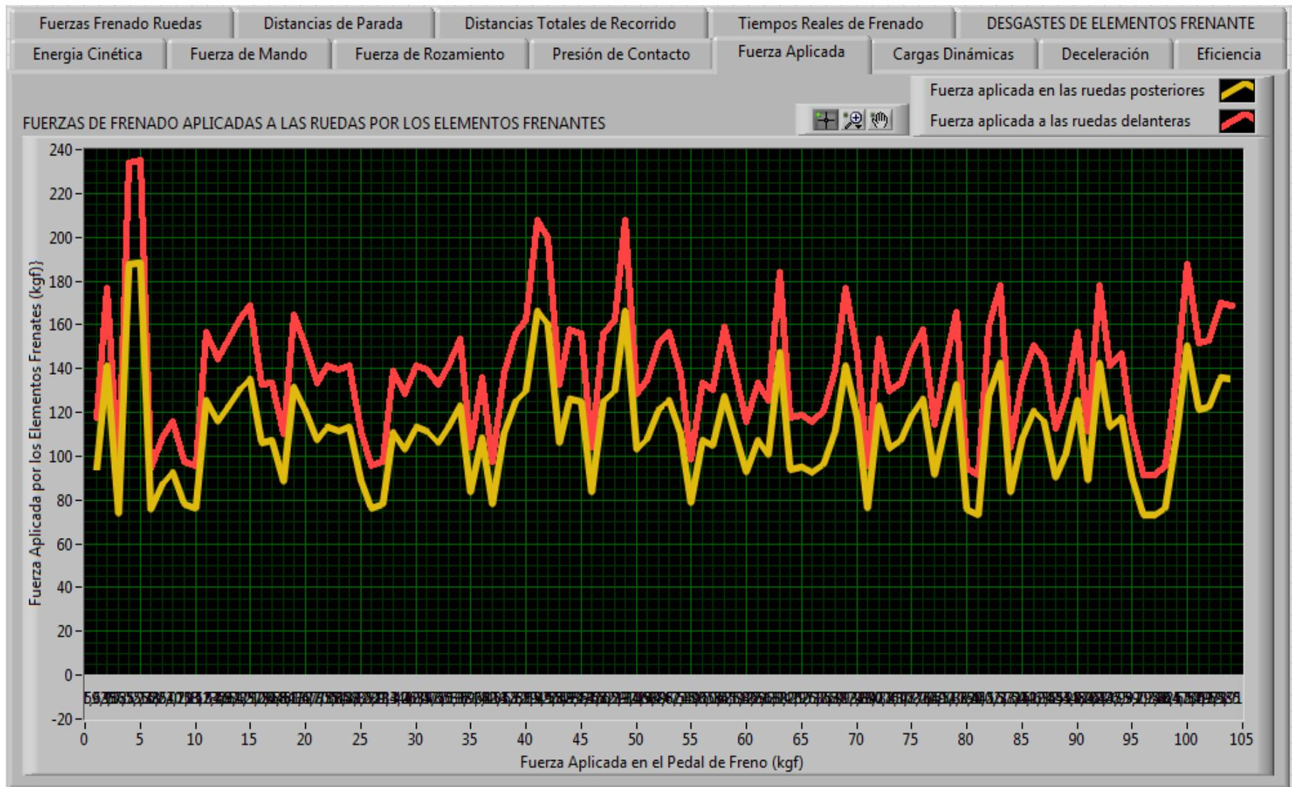
**Figura 4.19.** Fuerzas de Frenado Aplicadas por los Elementos Frenantes (Pastillas y Zapatas)
