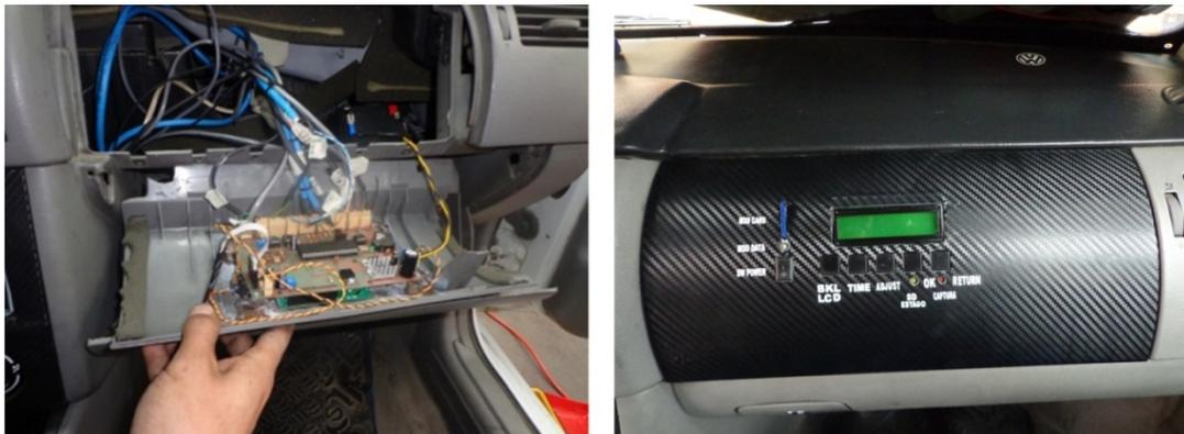
**Figura 3.46.** Instalación y Montaje Final del Circuito en el Vehículo.
