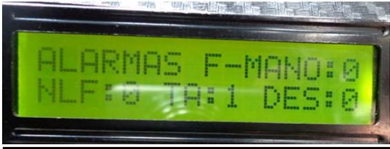
**Figura 3.32.** Activación de Alarmas de Desgaste en Pastilla o Zapata.
