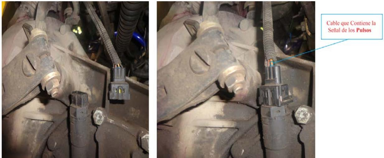
**Figura 3.20.** Cable de Conexión del Sensor VSS.
