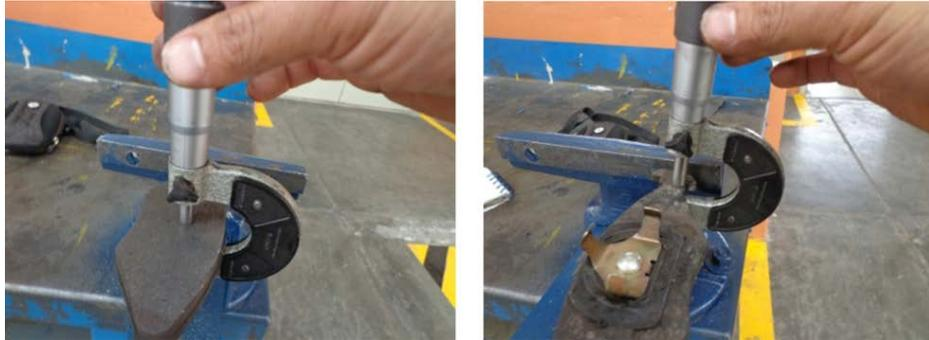
**Figura 4.40.** Obtención del Dato de Espesor de Pastillas.
