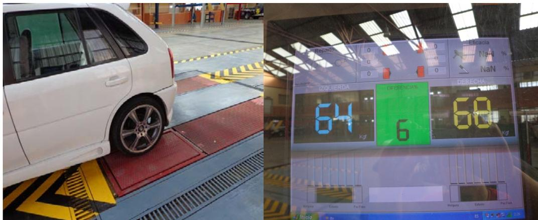
**Figura 4.23.** Fuerza de Frenado en Ruedas Posteriores.
