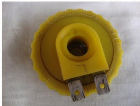
**Figura 2.8.** Vista Superior del Sensor de Nivel de Líquido de Freno.
