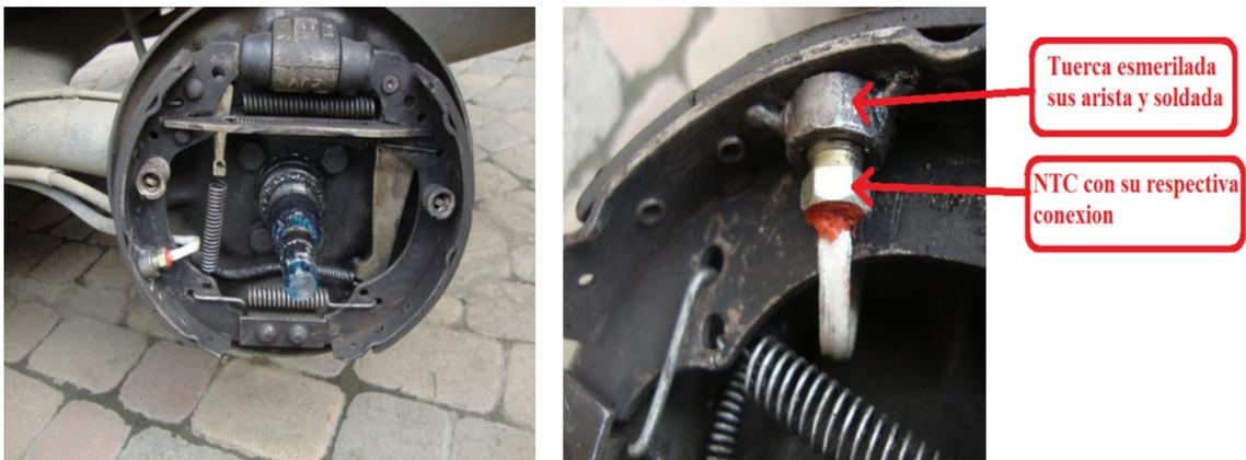
**Figura 3.23.** Soporte Tuerca de NTC en Zapata.
