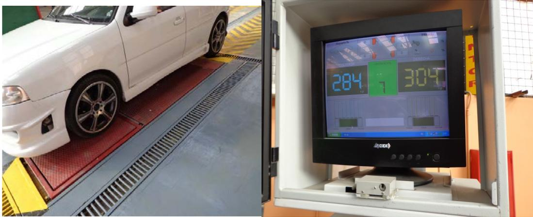
**Figura 4.22.** Fuerza de Frenado en Ruedas Delanteras.
