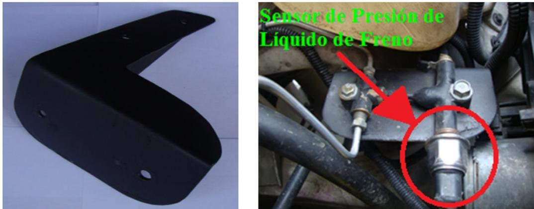
**Figura 3.33.** Base Soporte de Sensor de Presión y Temperatura.
