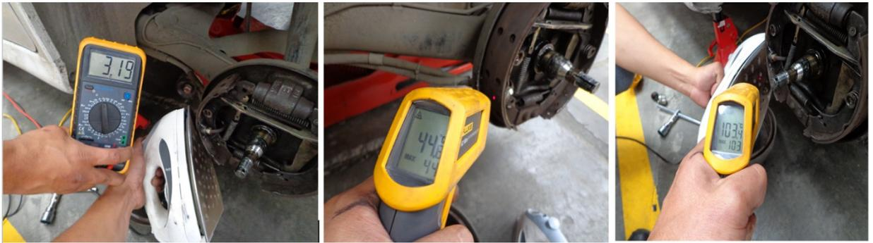
**Figura 3.24.** Adquisición de Datos de Temperatura en Zapatas.
