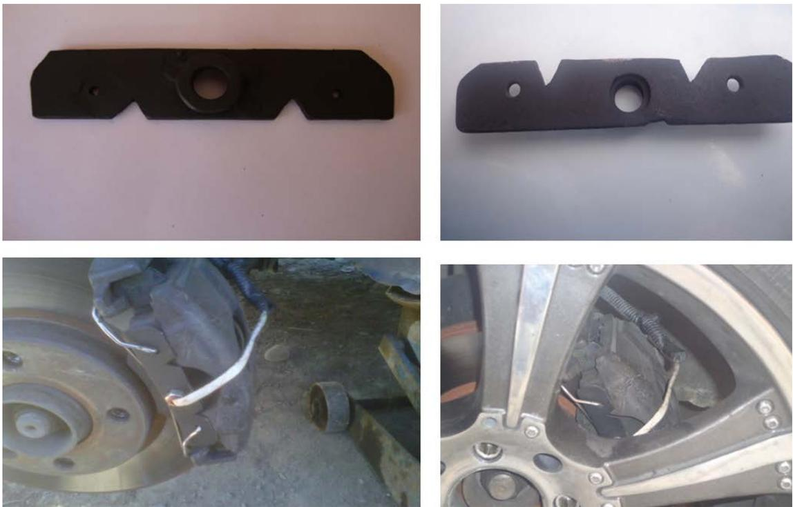
**Figura 3.26.** Soporte Placa para NTC Montadas en el Vehículo.
