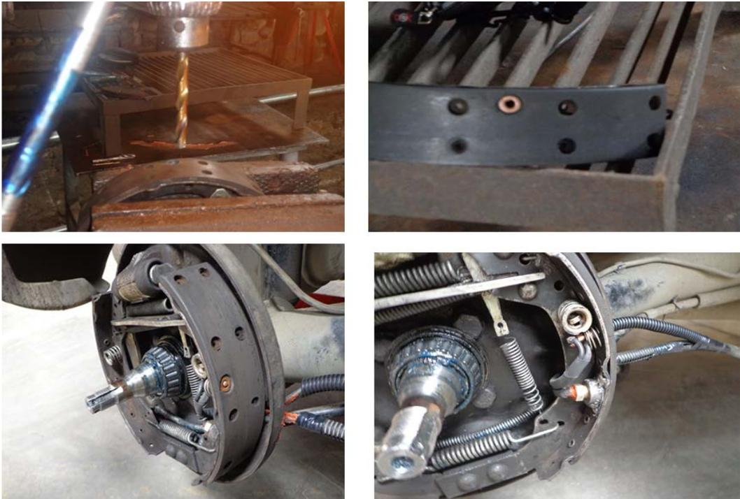
**Figura 3.31.** Adaptación de Dispositivo de Aviso de Desgaste en Zapata.
