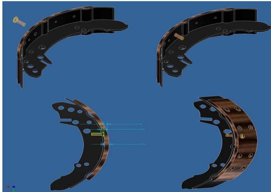
**Figura 3.13.** Diseño para Desgaste en Zapata.
