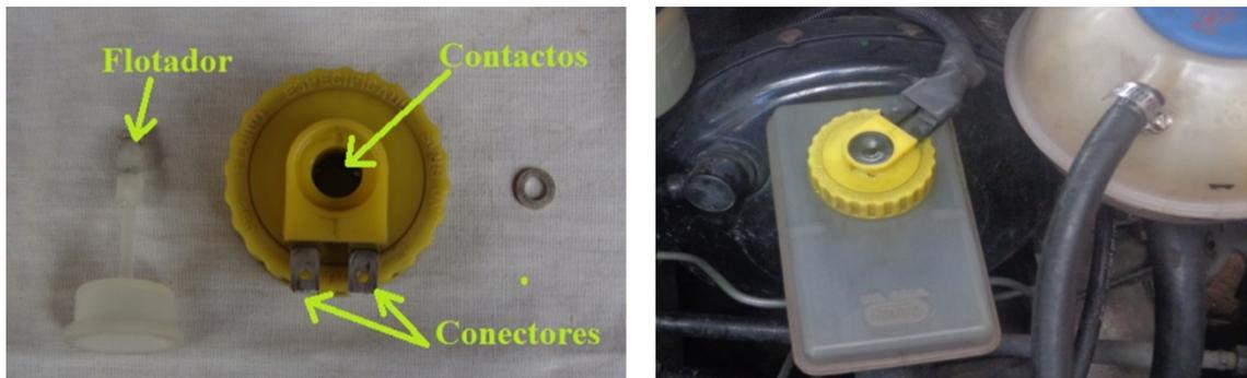
**Figura 3.38.** Instalaciones de Contactos en Tapa del Depósito de Líquido de Frenos.
