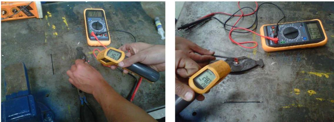
**Figura 3.27.** Toma de Datos de Temperatura de las Pastillas.
