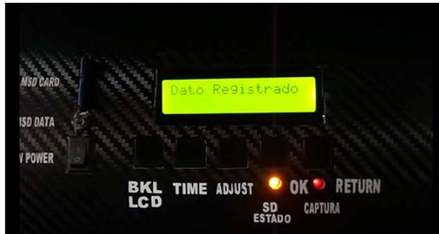
**Figura 3.58.** Funcionamiento del Sistema Cuando se Registra un Dato.
