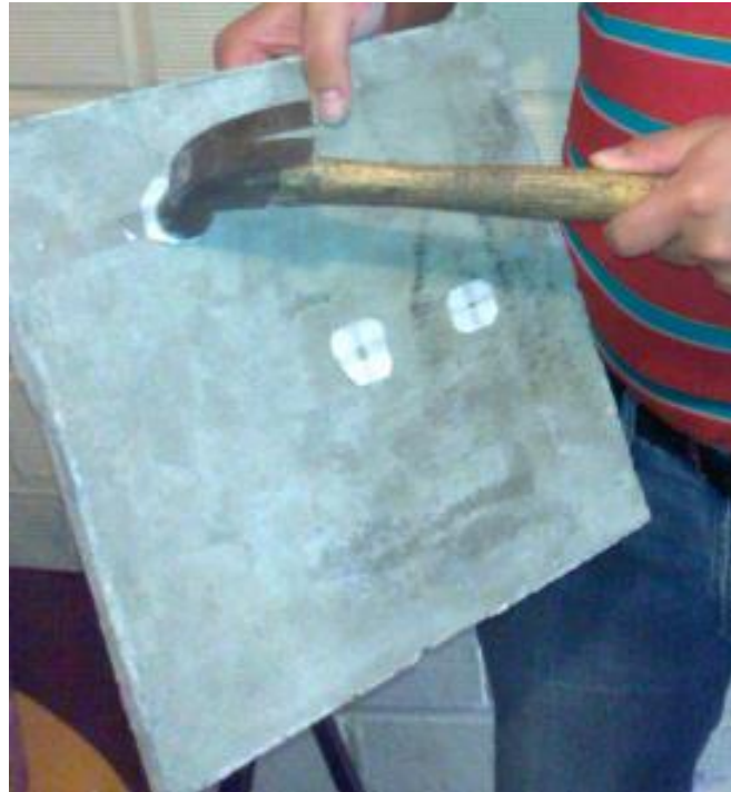
Figura 3.14: Verificación de solidez en paneles
