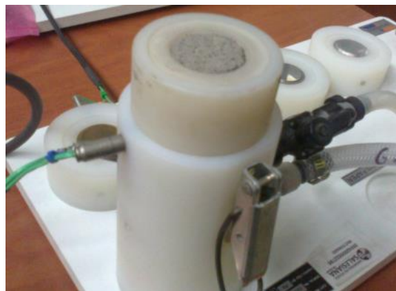
Figura 3.18: Cilindro insertado en confinamiento controlado de experimentación
