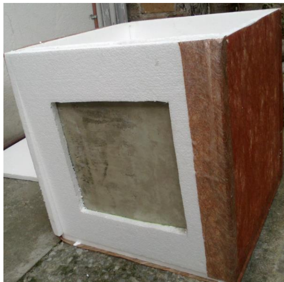
Figura 4.16: Diseño de maqueta para ensayo acústico en paneles
