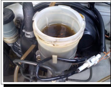
Figura 2.9.: Colocación de Líquido de Frenos. Fuente: Los Autores
