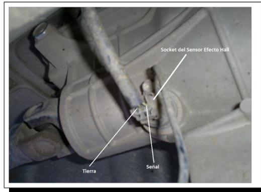
Figura 3.13.: Ubicación del Sensor Efecto Hall en la Caja de Cambios. Fuente: Los Autores
