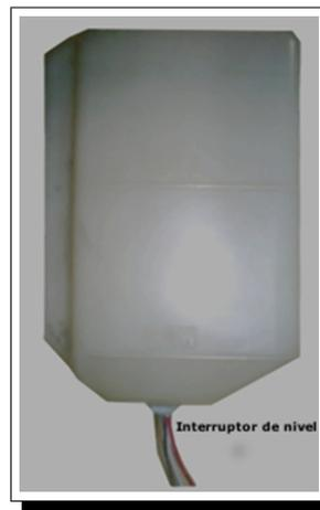
Figura 3.25.: Implementación del Interruptor de Nivel en el Tanque del Refrigerante. Fuente: Los Autores
