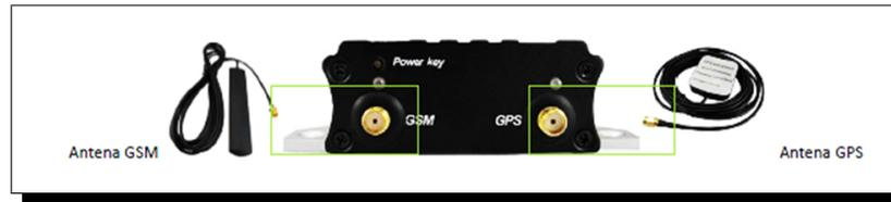
Figura 3.37.: Colocación de las Antenas GPS/GSM. Fuente: [13]
