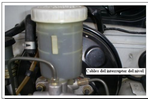
Figura 3.21.: Interruptor de Nivel del Automotor. Fuente: Los Autores
