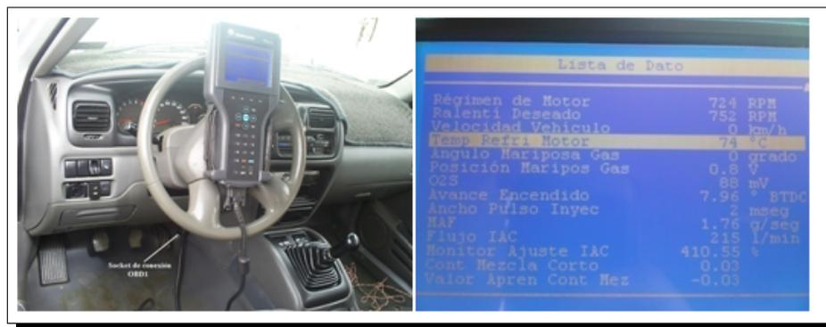
Figura 3.10.: Medición de la Temperatura del Motor con el Escáner Vetronix Tech.
