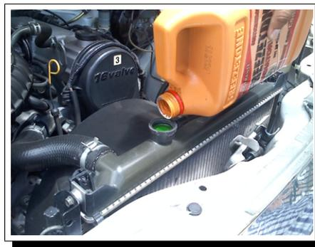
Figura 2.11.: Colocación del Refrigerante. Fuente: Los Autores
