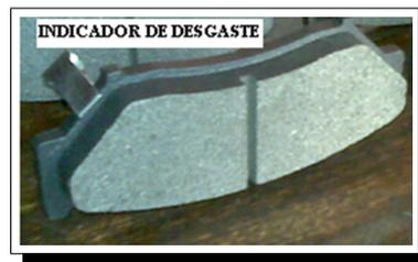
Figura 3.27.: Pastillas con Sensor de Chillido. Fuente: Los Autores
