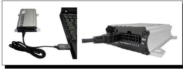
Figura 3.42.: Conexión del cable de datos USB. Fuente: [13]
