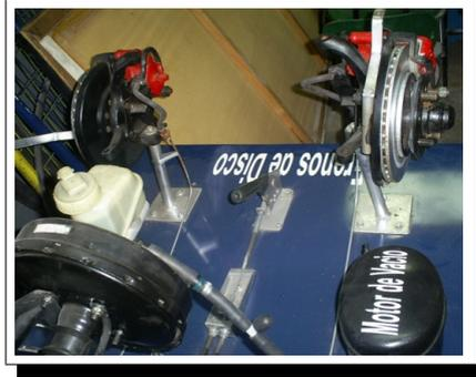
Figura 3.26.: Maqueta de Freno de Disco. Fuente: Los Autores
