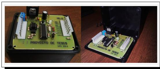
Figura 6.1.: Circuito de Adquisición y Acoplamiento de Señales. Fuente: Los Autores
