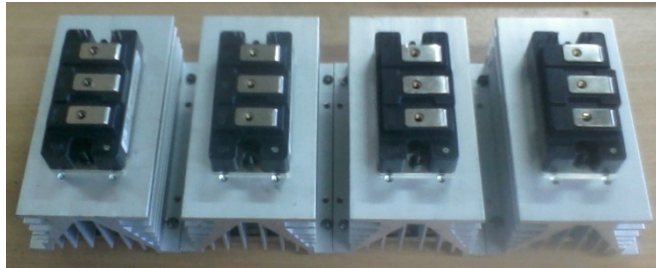
Figura 3.3. Colocación de los Módulos IGBT.
