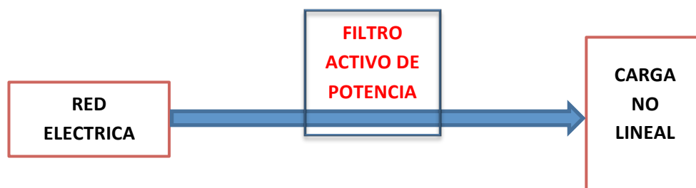
Figura 1.4. Esquema general de un FAP dentro de una red eléctrica.
