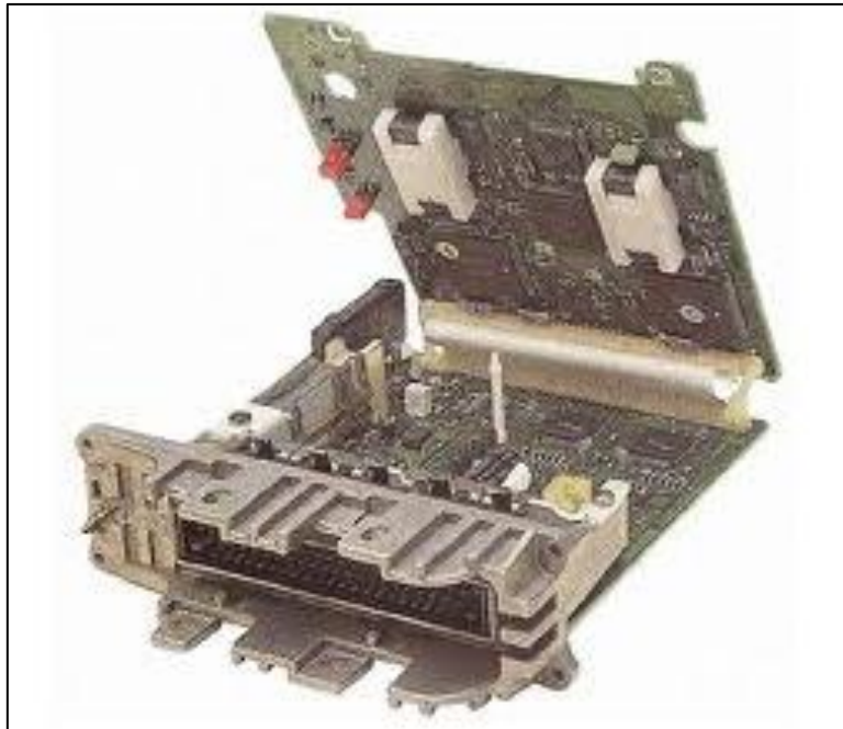
Figura 1.40: Unidad de control.
