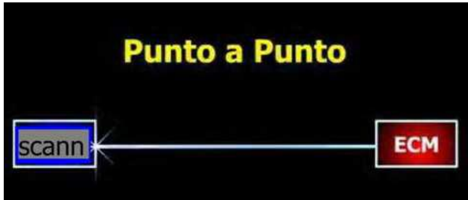
Figura 2.5: Configuración de red punto a punto. Fuente: UPS, Diapositivas de las clases de electrónica del automóvil.
