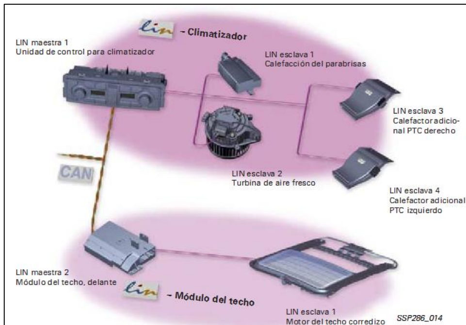
Figura 2.24: Intercambio de datos entre redes y multiplexado LIN-BUS.
