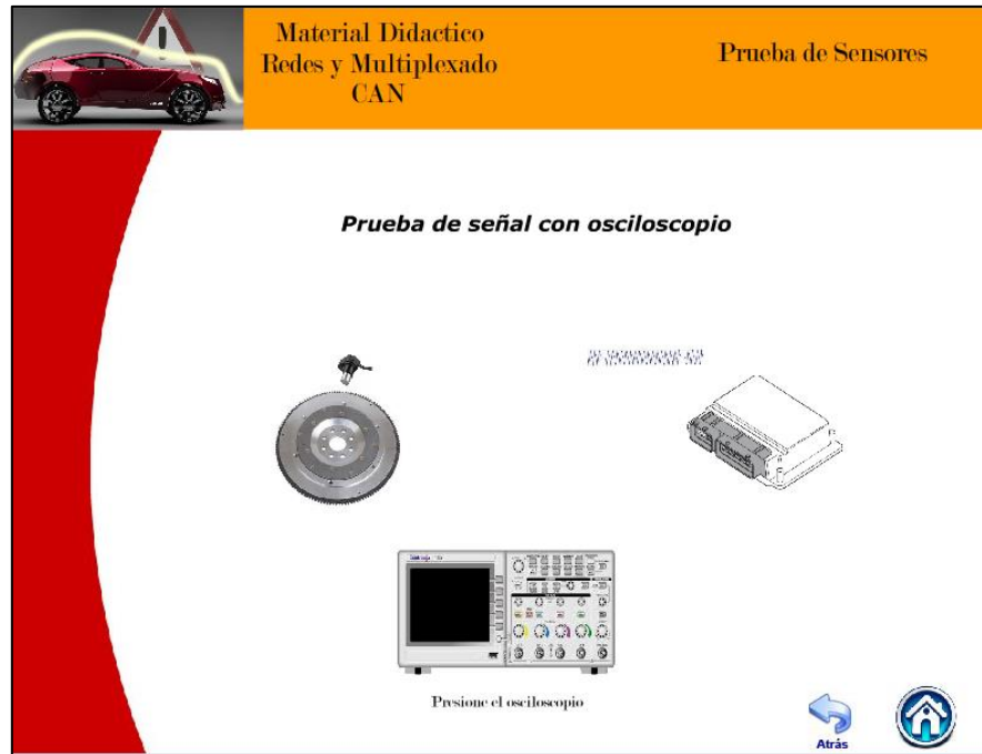
Figura 4.15: Prueba del sensor CKP. Fuente: Autores.
