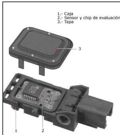
Figura 1.37: Sensor impacto frontal realizado por micromecánica de superficie. Fuente: http://www.aficionadosalamecanica.net/sensores3.htm .
