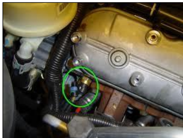
Figura 1.23: Ubicación del sensor ECT. Fuente: http://www.cadillacfaq.com/faq/answers/headers/16.jpg .
