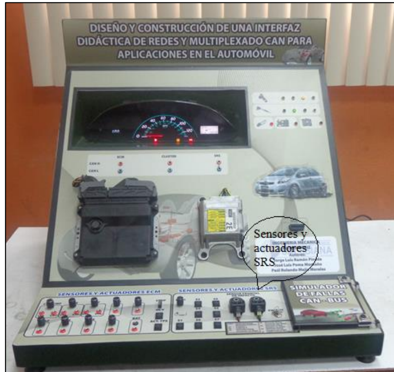
Figura 4.5: Sensores y Actuadores SRS.
