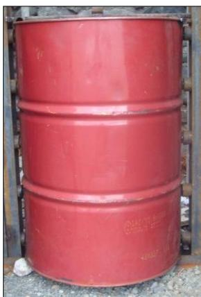
**Figura 2. 39.** Tanque para simular el peso.
