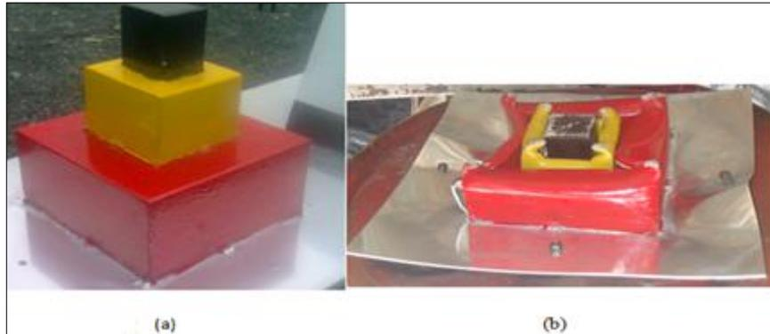
**Figura 3. 21.** *Atenuador Aluminio-Poliestireno Expandido. :(a) Atenuador fabricado, (b). Atenuador deformado*
