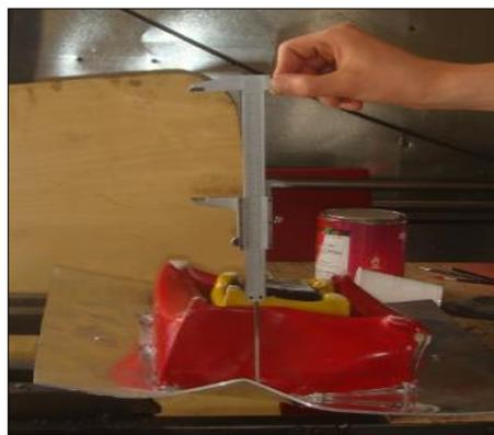
**Figura 3. 22.** *Medición de atenuador de Aluminio-Poliestireno Expandido.*
