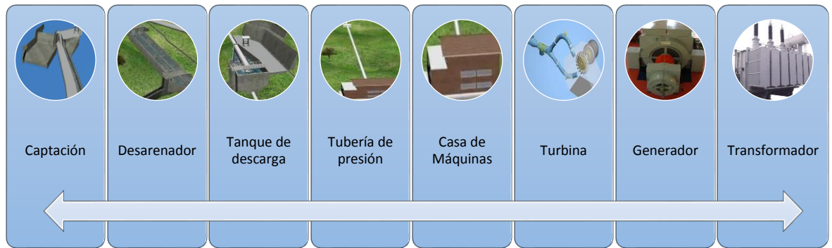
Fig. 1.3 Componentes Principales de la Central de Alazán. (Elaboración propia)
