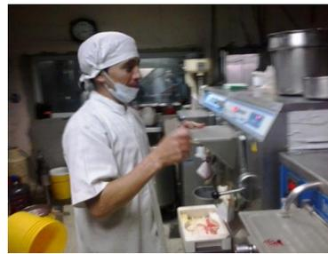
Existen máquinas en las cuales es necesario que la persona utilice una paleta para sacar el producto final así como otras en las que la máquina realiza todo el trabajo, más ya sea con los helados naturales o con esencias, de agua o de leche todo el proceso tiene que estar vigilado hasta su término (producto final).
