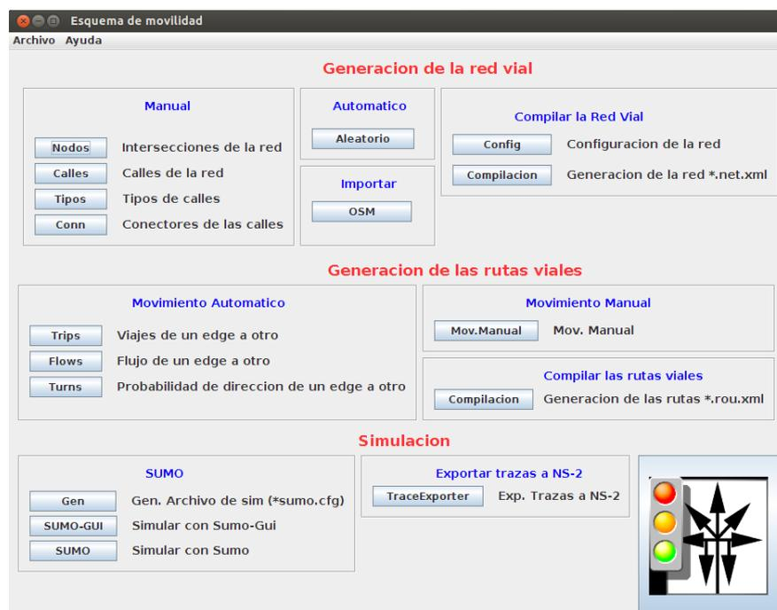
**Figura B.1.:** Pantalla de modelo de movilidad, tiene las funciones de generación de una red vial, generación de rutas vehiculares, compilación, ejecución, y exportación.
