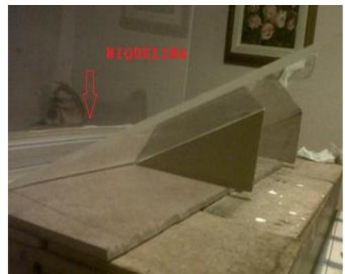
**Figura 2.10** Estructura elaborada para el termoformado del habitáculo
