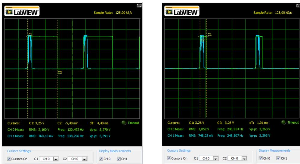
**Figura 2.18** Variación del periodo en la señal de salida a) 4.40ms b) 1.01ms
