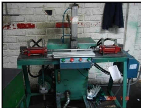
Figura 3.65 Rectificadora de tubo de combustión.
