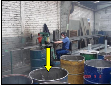
Figura3. 51 Almacenaje actual de varillas cortadas.
