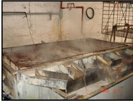
Figura 4.4 Tanque de desengrase calentado a 75°C.
