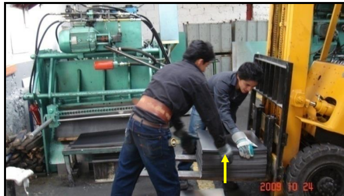
Figura 3.27 Descarga de planchas del recorte al montacargas.
