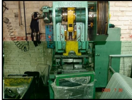
Figura 3.62 Prensa excéntrica de 30 TN y 5 HP.
