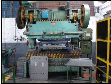
Figura 3.13 Prensa excéntrica de 100 Tm
