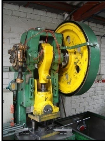
Figura 3.64 Prensa excéntrica de 9 TN y 0,5 HP.
