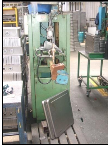
Figura 3.23 Soldadura de Puntos 10
