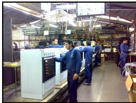
Figura 2.24 Ensamble de cocinas.
