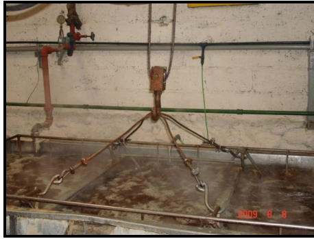
Fig. 4.8 Eslinga o cable de acero sujeto a la cesta.
