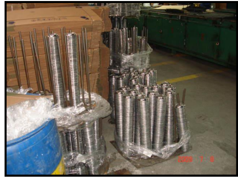
Figura 7. 46 Almacenamiento de bases quemador.
