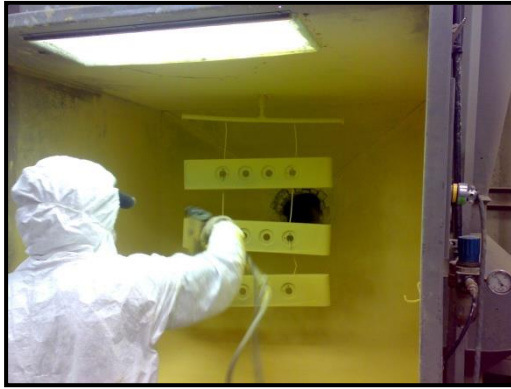
Figura 2.20 Pintura por aspersión
