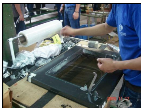
Figura 7.65 Armado de puerta de horno.
