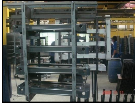
Figura 5.14 Cajones BARI 3Q en el utillaje de para quemar.
