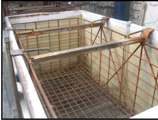
Figura 4.1 Cesta colocada en un tanque vacío, se puede observar cómo se acopla la cesta en el tanque.
