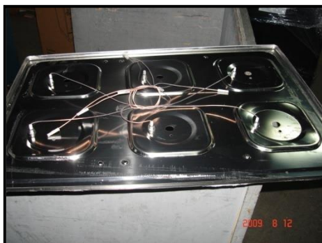
Figura 12. Pre-armado de tablero actual.
