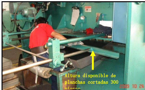
Figura 3.24 Corte de planchas en la cizalla 101-05
