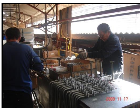
Figura 7.60 Armado de tubo rampa.
