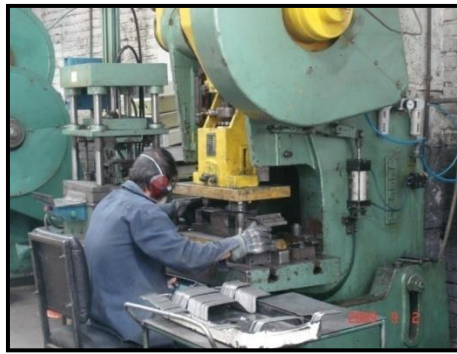
Figura 3.41 Prensa excéntrica de 80 TN.
