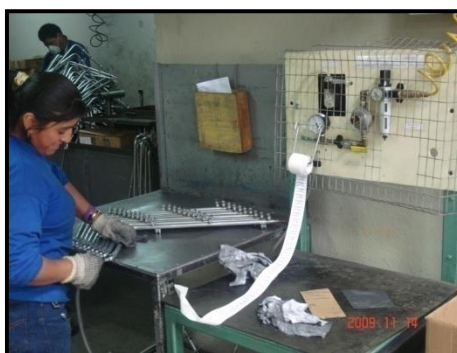
Figura 7.5 Prueba de fugas.
