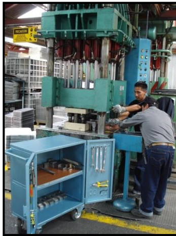
Figura 3.3 Montaje - Desmontaje de matrices.
