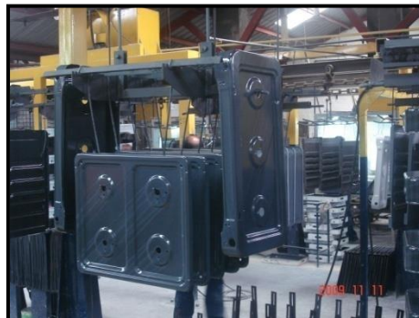
Figura 5.15 Utillaje para quemar tablero Fiorentina con Cajones BARI 3Q.
