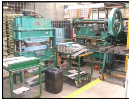
Figura 3.22 Prensas hidráulicas de Troquelar y
