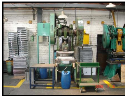
Figura 3.15 Prensa excéntrica de 90 TN.
