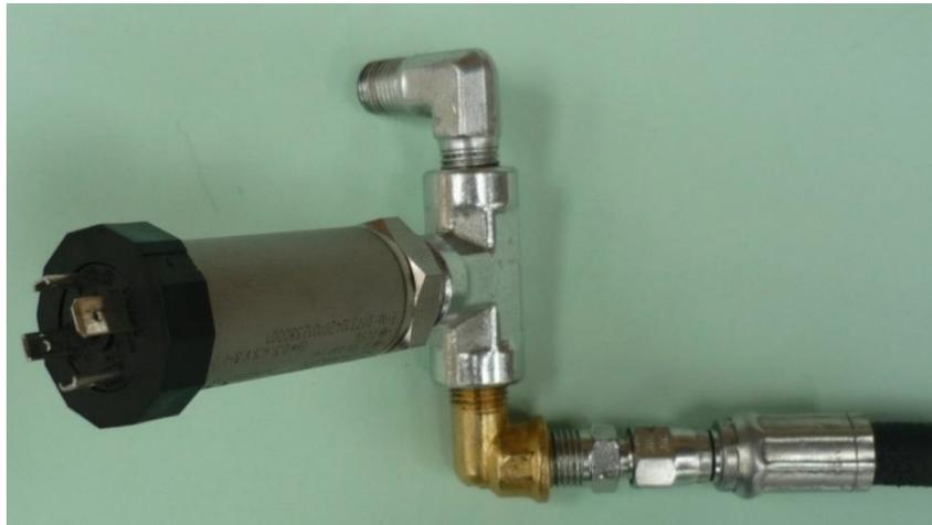
Fig. 75. Acople para el Sensor de Presión
