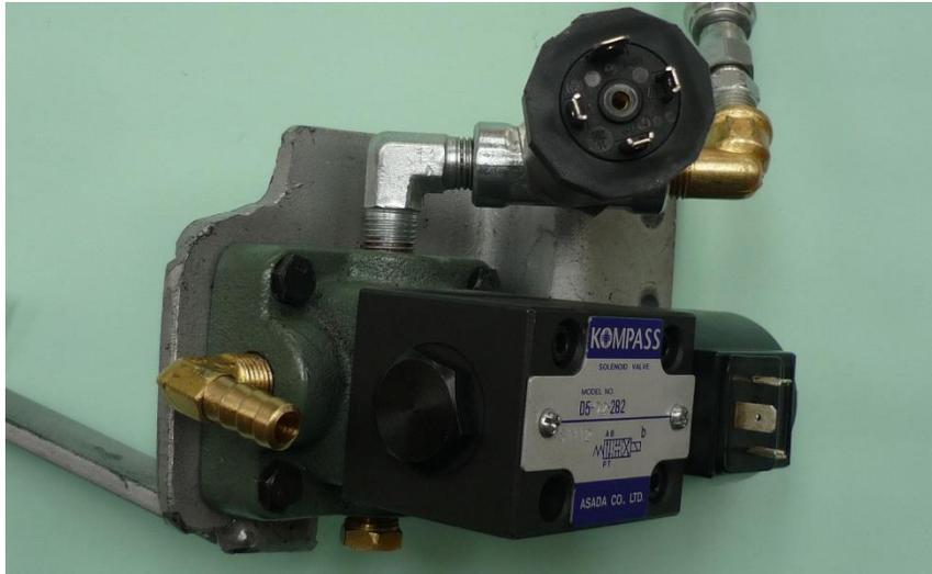
Fig. 76. Instalación los Acoplen con el Cuerpo Hidráulico.
