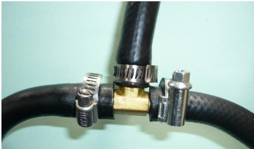
Fig. 77. Instalación de la Cañería de Retorno
