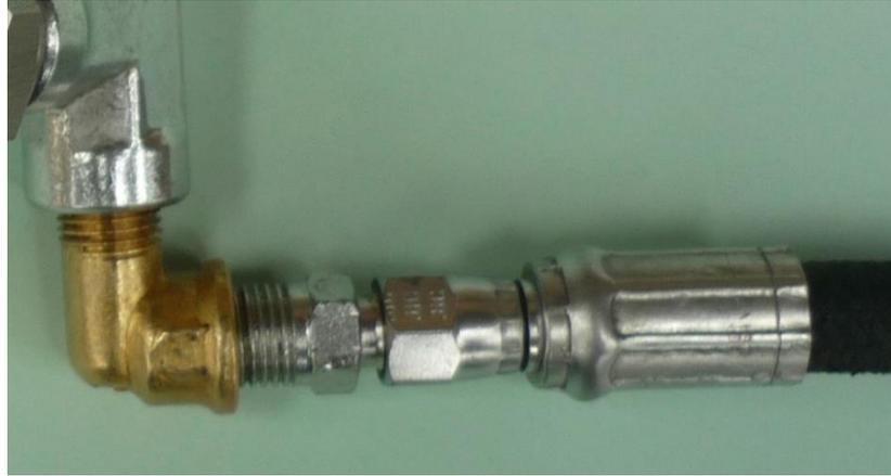
Fig. 74. Instalación de Codos y Uniones en el Sistema de Dirección
