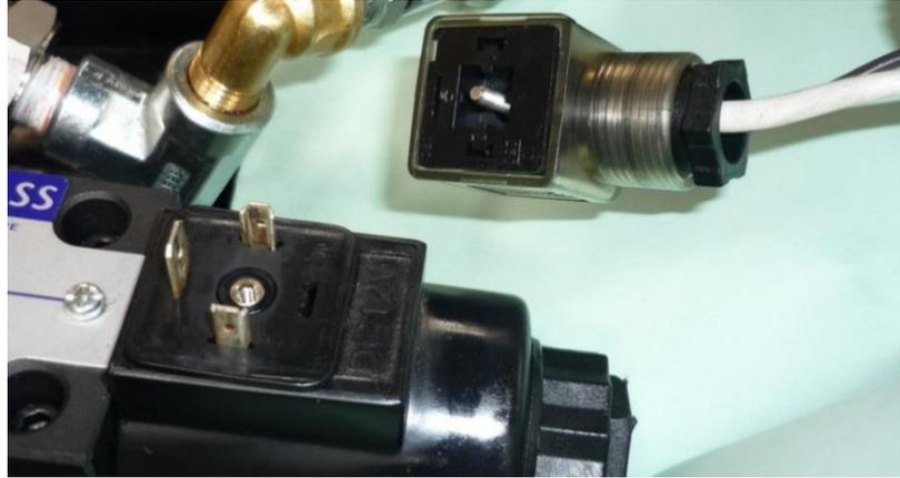
Fig. 66. Conexionado de la Electroválvula
