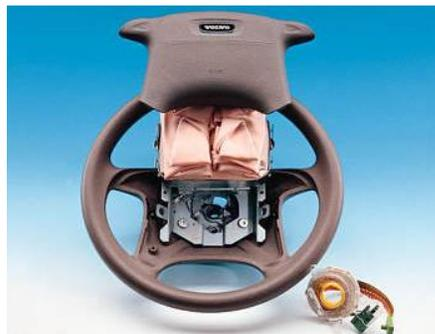
Fig. 18. Airbag Volante
