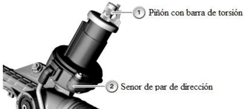
Fig. 25. Sistema de Dirección Hidráulica con Asistencia Variable
