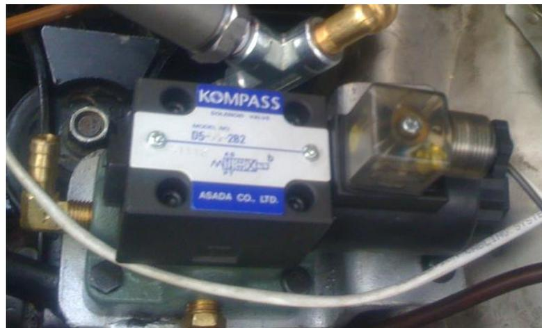
Fig. 72. Montaje de la Electroválvula en el Vehículo
