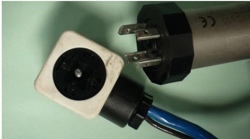
Fig. 67. Conexionado del Sensor de Presión
