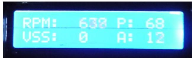
Fig. 88. Presión del Sistema de Dirección Hidráulica Sin el Sistema de Control en su Tope Mecánico
