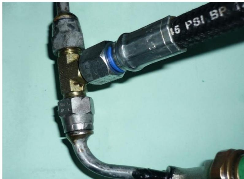
Fig. 73. Instalación de la Cañería y Acoples para la Derivación del fluido Hidráulico
