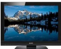
**Televisor.-**Video, tamaño de pantalla 32", Resolución 1.366 x 768, Audio Salida de Sonido (RMS) 5 W x 2, Entrada y Salida Componente (Y/Pb/Pr) 1, Compuesto (AV) 1, HDMI 2, Dimensión Tamaño, (AnxAIxP) con base 795,3 x 585,3 x 247,2 mm, Peso con base 7,6 kg<sup>17</sup>
