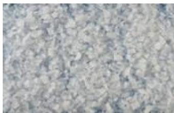
**Hielo macro:** Trozos de hielo de hasta 9.5 mm de espesor. El hielo macro es especialmente resistente y apto para el almacenamiento largo. Ofrece una refrigeración constante para el transporte de pescado.
