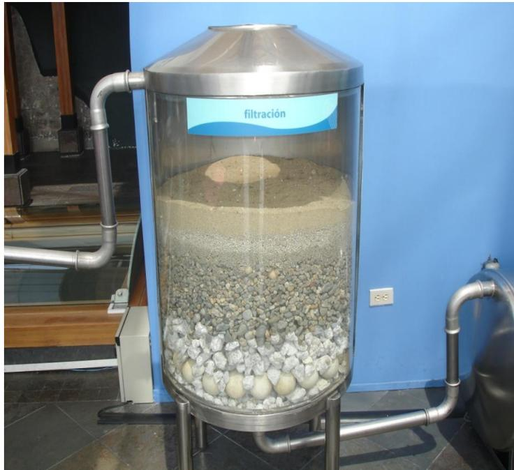
Figura N° 6 Tratamiento del agua mediante filtración por arena.
