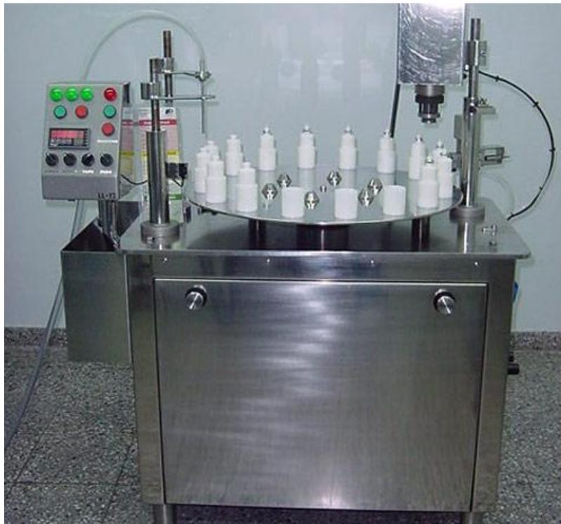
Figura N° 11 Llenadora de líquidos rotativa lrt
