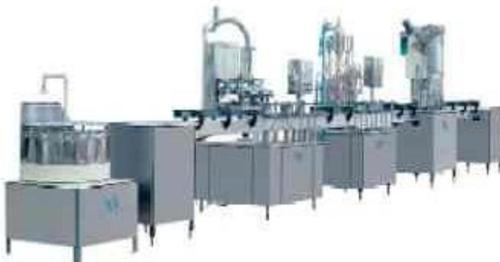
Figura N° 10 Línea de Envasado para Botellas de 600mL
