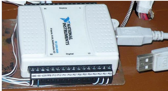
Fotografía 4. 1 Tarjeta DAQ Multifunción I/O NI USB-6009
