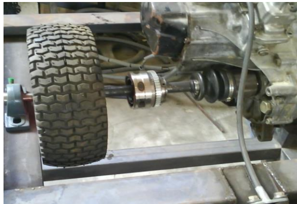
FOTOGRAFÍA 2. 3 Sensor de Señal de Salida.
