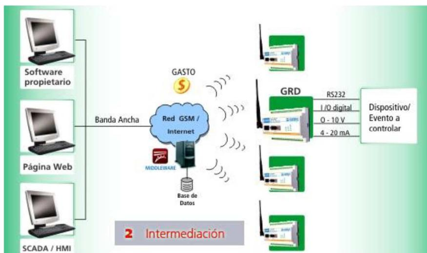
**Figura 12:** Esquema de Telemetría [3]
