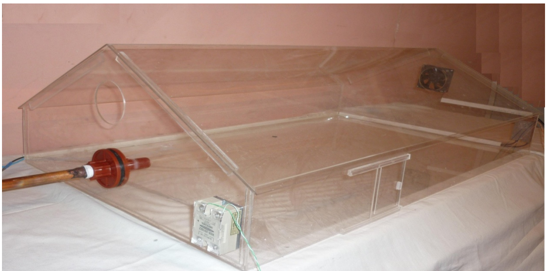
Figura 3.4 Planta física del invernadero a escala
