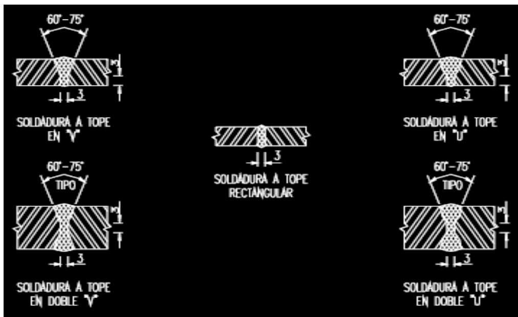
Figura 66. Detalles típicos de soldaduras longitudinales
