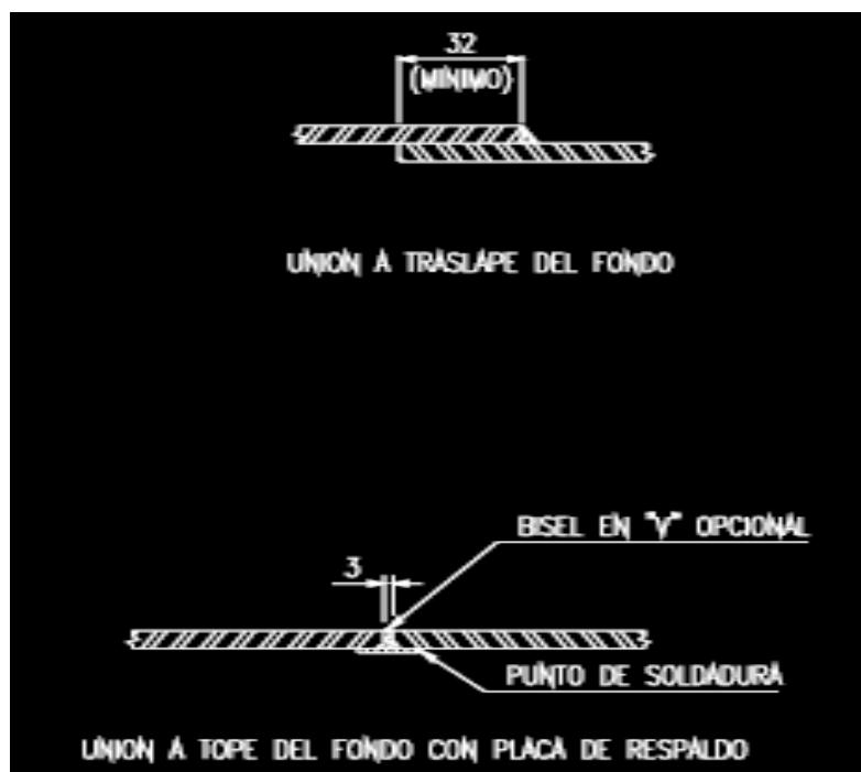
Figura 68. Detalles típicos de soldadura de fondo
