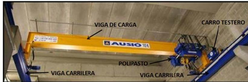
**Figura 3.3** Partes de un puente grúa monorriel
