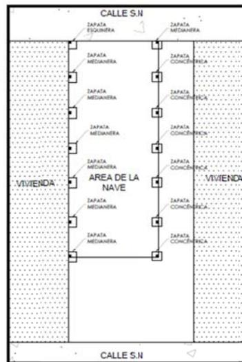
**Figura 2.54 Ubicación de zapatas de cimentación**
