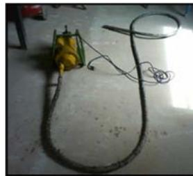
**Figura 1.26. Vibradora**
