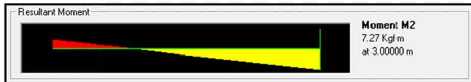
Figura 2.33 Diagrama de momento flector sobre las correas eje y
