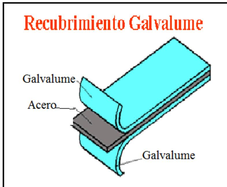
Fig.12 Adherencia química del galvalume.
