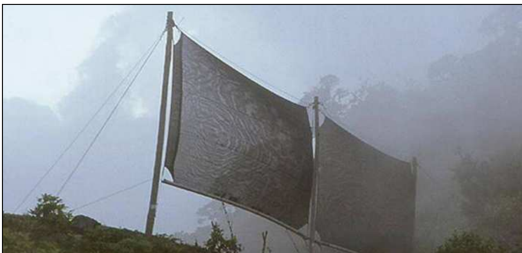
FIGURA 1.29 MALLA RECOLECTORA DE NIEBLA, FUENTE PILAR CERECEDA CAPTACIÓN DE NEBLINAS FUENTE: INVESTIGACION PROYECTO ECOLOGICO PAICALOMA TUMBACO
