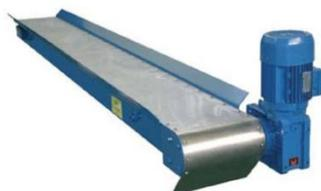
• Cama deslizante de calibre 12, instalada en canales de acero de 6-1/2 pulgadas de profundidad y acabados con pintura electrostática.
