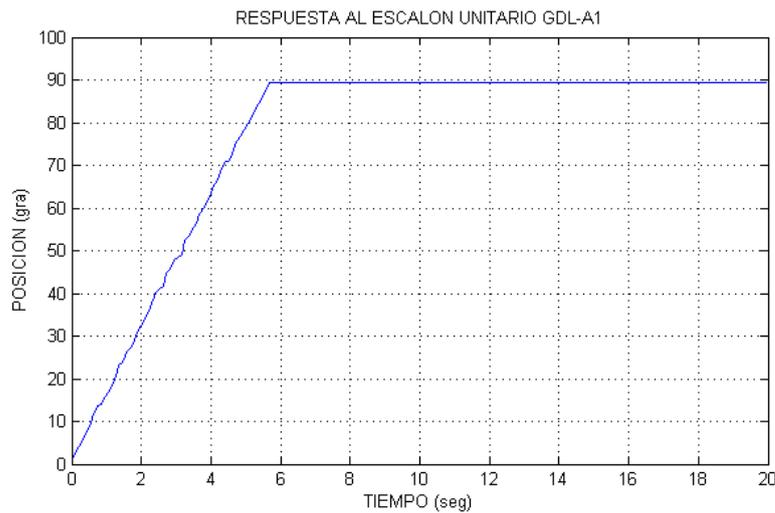
Figura 68. Respuesta física a un movimiento puntual del GDL1.
