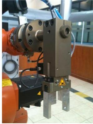
Figura 18. Garra de sujeción.
