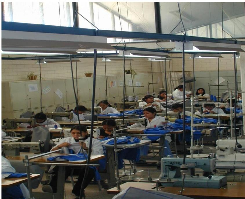
La maquinaria está distribuida para realizar una producción en línea, cada máquina cuenta con una conexión eléctrica aérea.
