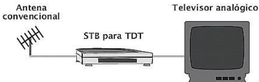
*Figura 1. 4 Recepción de TDT con STB (Orozco, 2011)<sup>17</sup>*
