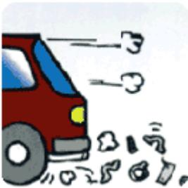
**Estallidos:** a causa es, probablemente, agujeros en el sistema de caño de escape. La solución es substituir la pieza damnificada por otra nueva.
