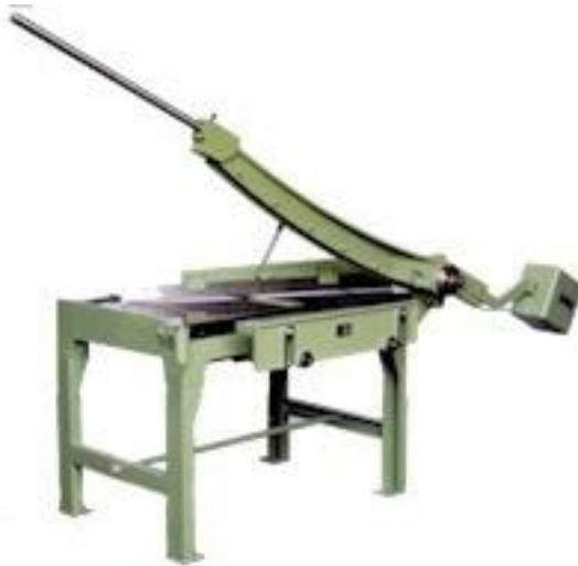
Se denomina Cizalla a la máquina de obra que se utiliza para cortar metales. Funciona de igual manera que una tijera común, sólo que permite mayor potencia y precisión en el corte. Puede ser manual o eléctrica.
