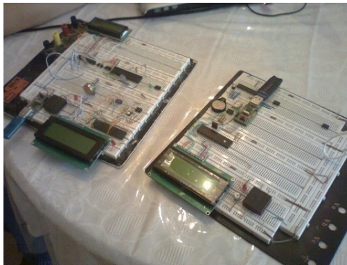
Figura 70 Pruebas en Protoboard (Módulos Registro de Datos)
