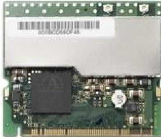
**Figura 3.7** Tarjeta Intel pro/wireless mini pci 802.11 b/g
