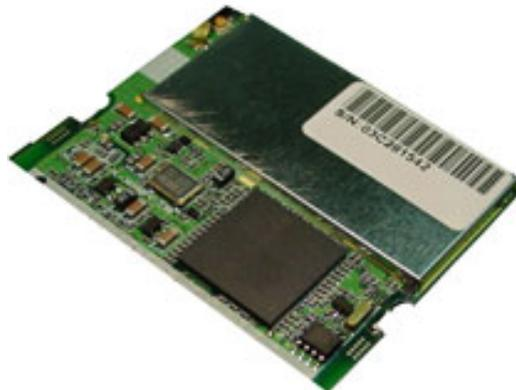
**Figura 3.2** Tarjeta inalámbrica MiniPCI
