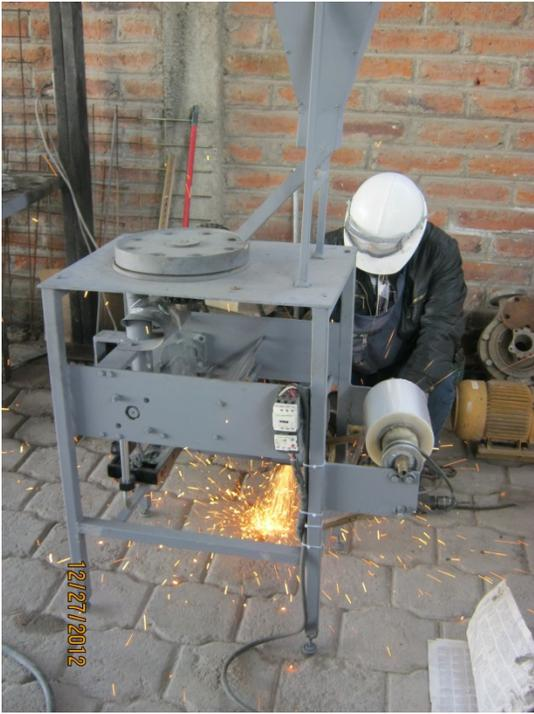
**Armado final de la máquina dosificadora y selladora**
