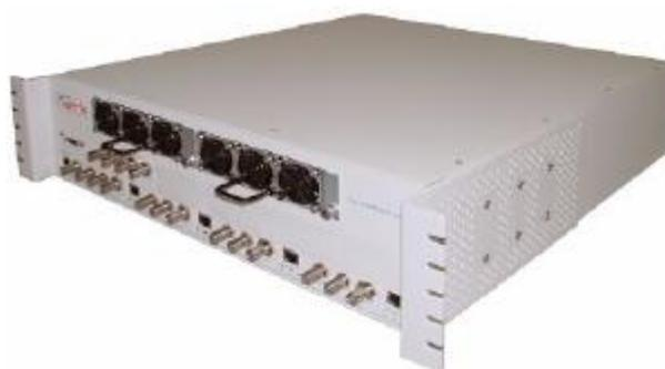
**Imagen 3.28:** Estación Base PacketWave<sup>78</sup>
