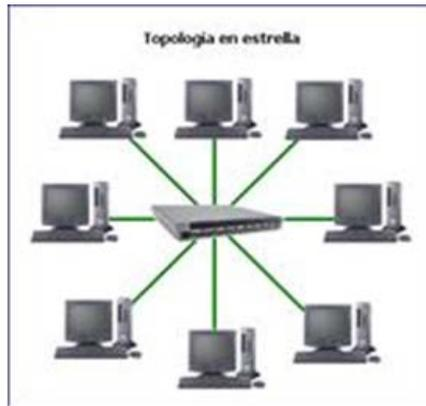
Fig. 1. 4. Diagrama de Ethernet Estrella <sup>4</sup>
