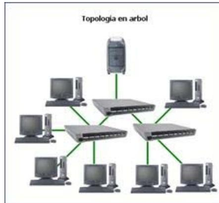
Fig. 1. 6. Diagrama de Ethernet Árbol <sup>6</sup>
