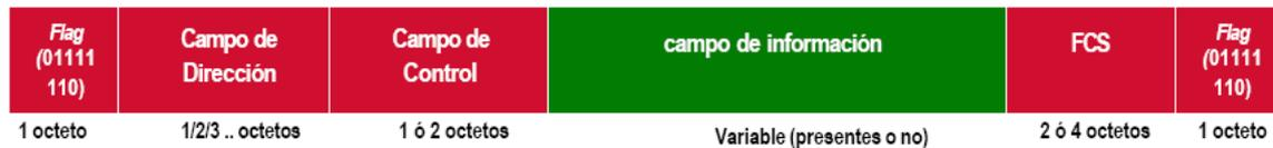
Fig. 1. 14. Esquema de la Trama HDLC<sup>16</sup>
