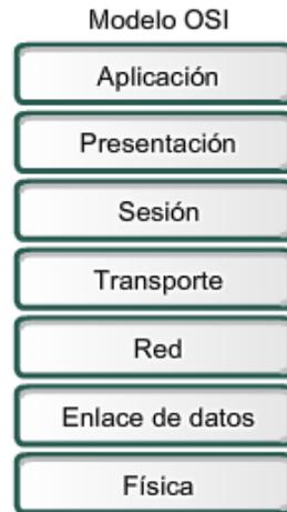
Fig. 1. 19. Modelo de referencia OSI <sup>21</sup>
