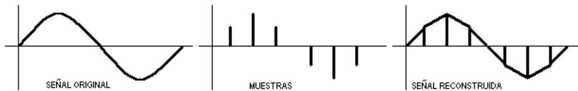
Fig. 2. 3. Muestreo de una señal analógica<sup>41</sup>
