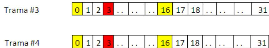
Por cada trama E1 se procesan dos bytes de control (control y sincronismo) y para este caso se tiene un total de 8 bytes de control y cuatro de datos.
