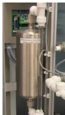
Figura 2. 11 Tanque de presión.
